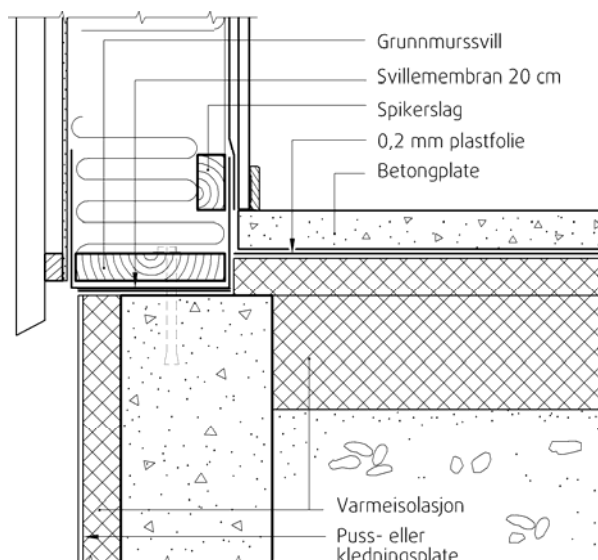
Fig. 3 Alternativ løsning med bruk av Icopal Svillemembran 20 cm på ringmur isolert på utsiden og golv på grunnen.
